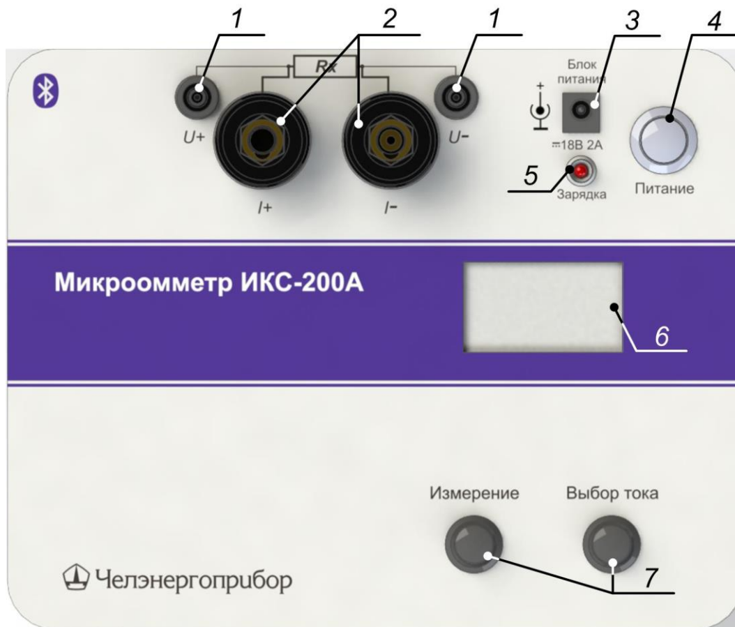
Рисунок 2 – Лицевая панель прибора ИКС-200А
